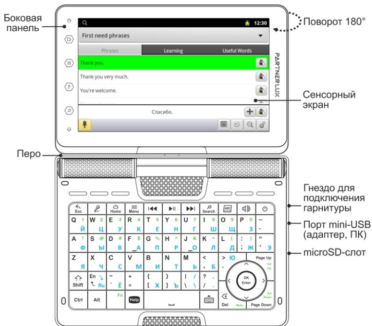
Благодаря поворотному экрану устройство легко трансформируется в удобный планшет. Допустимый угол поворота экрана от исходного положения – 180° по часовой стрелке. Возврат экрана в исходное положение осуществляется поворотом на 180° против часовой стрелки.
